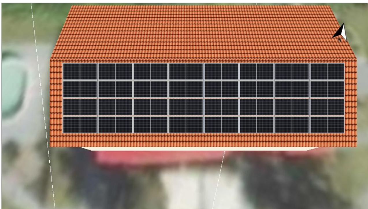
Ilustracja: 5. Powierzchnię modułu - Budynek 06-Powierzchnia dachu Południe
